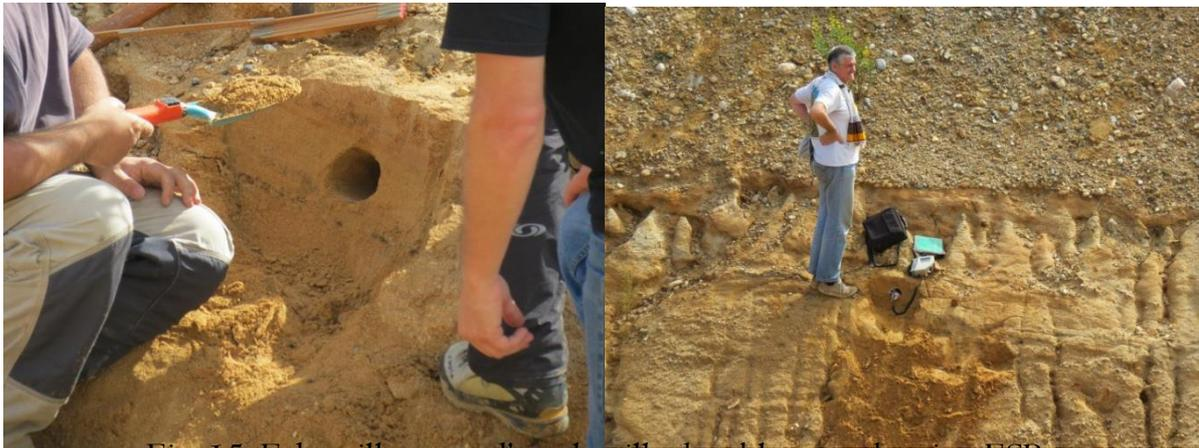
Fig. 15. Échantillonnage d'une lentille de sable pour datation ESR.
