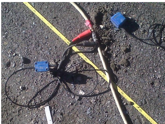
Figura 5: Geòfons connectats al cable sísmic (fotografia Martí Roset).
