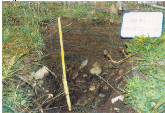
Fig. 3: Pedió nº25 al Pla de l'Inglà (2180 m), classificat com un Fluvisòl dístric.
